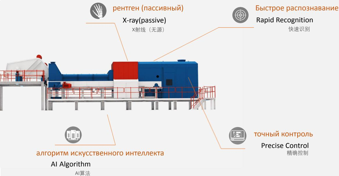
Оно широко используется при разделении металлических / неметаллических руд, промышленных руд, энергетических минералов (обогащение угля), шлаков, алмазов, отходов и т.д.
