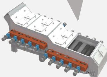
Дисковый грохот широкой классификации серии DFRS используется для обесшламливания рядового угля с целью снижения нагрузки на водно-шламовую схему и улучшения общей производительности обогатительной фабрики.
