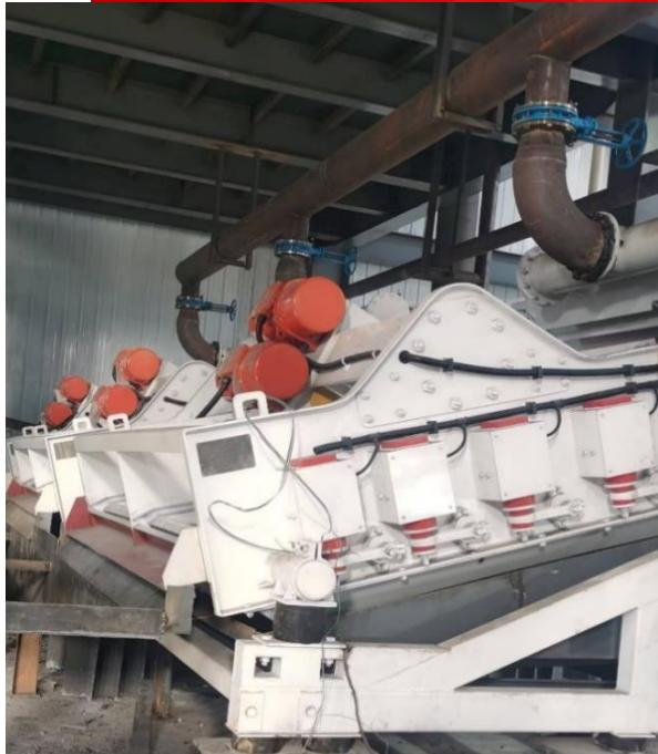
复合振动电磁筛在高频电磁筛基础上增加了两台激振电机，构成双质体振动，既达到了极佳的脱泥效果，又提高了处理能力。
