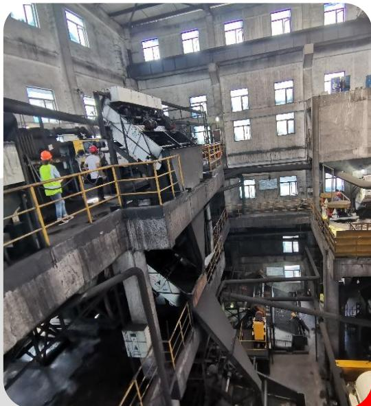
三质体高频复合脱水筛采用增强的电磁振动系统，通过精确控制振动频率，确保物料在筛分过程中不仅完成高效的分选，还能实现极高的脱水效果。
